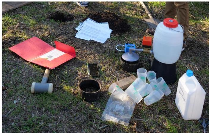
Figure 1. Matériel pour mesurer la capacité d'infiltration de l'eau dans le sol - Méthode Beerkan adaptée par Rhizobiome. © JMS 2022 - Petitas
