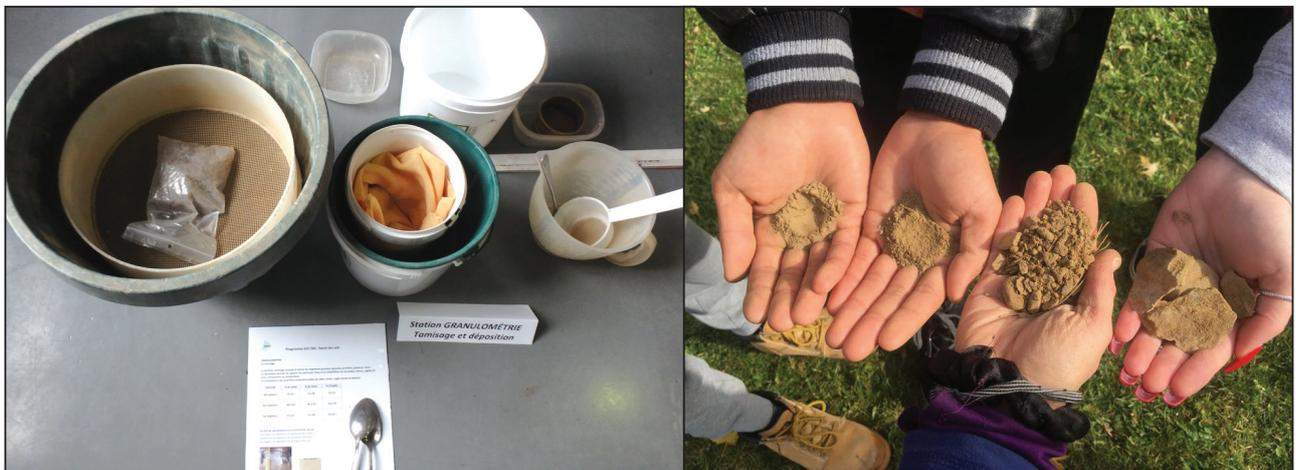
**Figure 6 -** Évaluation manuelle de textures de sol par la technique du ruban, pour déterminer la proportion d'argile, de limon et de sable.
