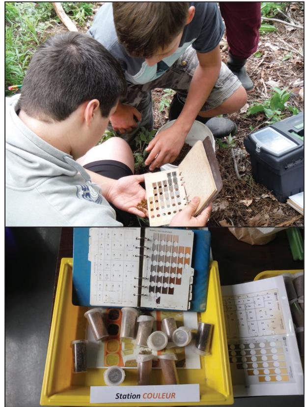
**Figure 5 - Évaluation de la composition d'un sol, tamisage des fragments fins à grossiers, ainsi que des particules, des sables aux argiles.**
