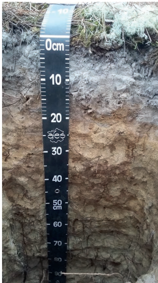
Figure 2 : Profil de sol d'un podzsol meuble issu de sable des landes (référentiel pédologique 2008), sous une plantation de pins maritimes en lande sèche. Site FCBA de Préchac (GIS Coop de données), département de la Gironde, France. Fosse pédologique réalisée par L. Cécillon, L. Soucemarianadin et A. Delahaie.
