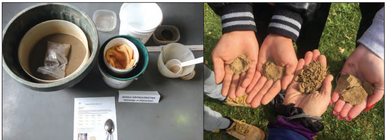
Figure 5 - Évaluation de la composition d'un sol, tamisage des fragments fins à grossiers, ainsi que des particules, des sables aux argiles. Figure 5 - Test of soil components, sieving rough to fine gravels and sand to clay particles.
