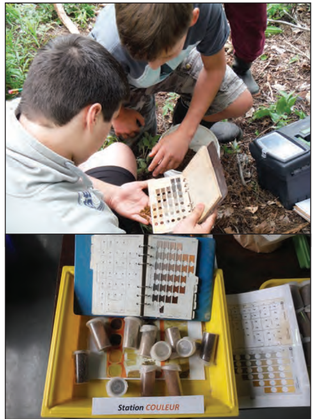
Figure 4 - Évaluation de la couleur d'un sol à partir du guide Munsell d'identification des couleurs. Figure 4 - Color test with the Munsell guide.
