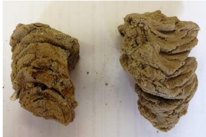
Plissage des argiles sous l'effet de la dent de sous-solage (modalité Culti3B)
