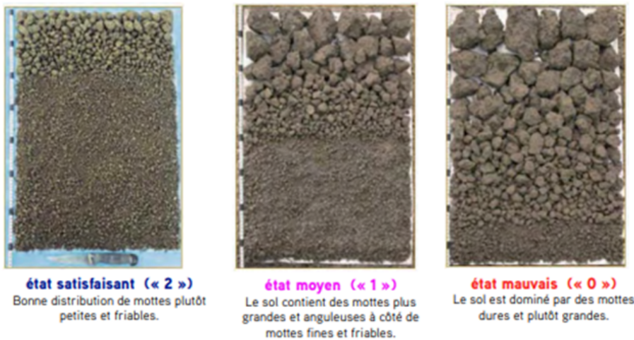
Figure 2. Résultats de trois drop-test sur des sols compactés (à droite) ou non (à gauche) 7 .
