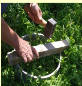
Figure 3 : Enfoncer le cylindre PVC dans le sol (1 à 2 cm)
