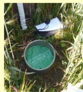
Figure 5 : Utiliser un voile « antisplash » pour éviter la déstructuration du sol
