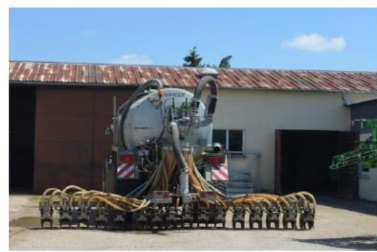
Enfouisseur (source chambre)
