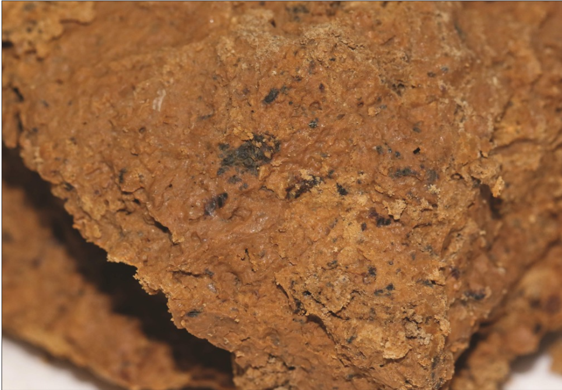
Figure 1: Revêtements argileux rougeâtres sur faces d'agrégats. Horizon BT d'un Luvisol Typique (photo N. Duigou) - Ils sont cireux, lisses, brillants, et présentent des teintes plus vives que la matrice. Figure 1: Reddish clay coatings on aggregate faces. BT horizon of a "Luvisol Typique". They are waxy, smooth, shiny, and have brighter hues than the matrix.
