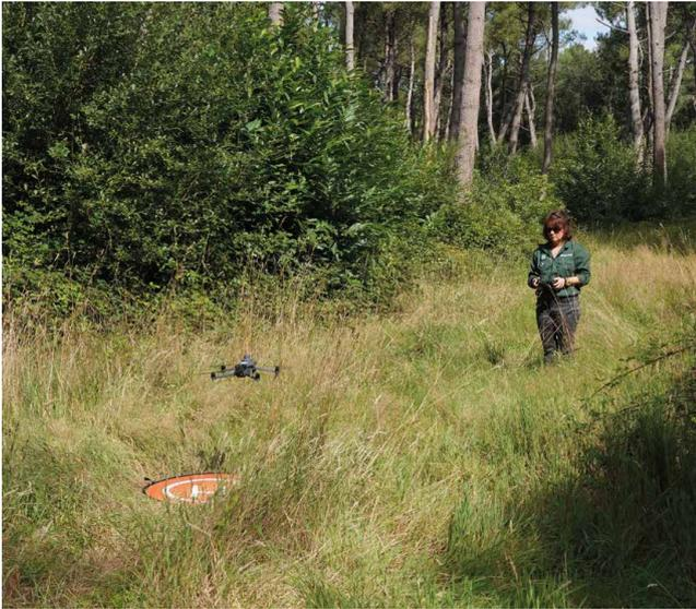
↑ **Figure 1.** Télépilote faisant décoller son drone catégorie spécifique (Mavic3 Enterprise) pour une acquisition d'orthophotos.
