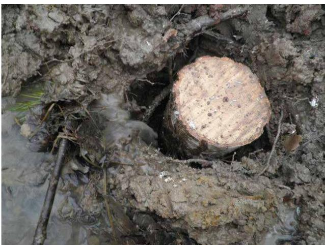
↑ **Figure 6.** Dispositif de test de la restauration de la praticabilité des cloisonnements par perforation verticale profonde en Forêt Domaniale de Fénétrange. Photo dessus : ornières avant restauration. Photo dessous : perforation du fond de l'ornière et mise en place de pieux pour éviter que la perforation ne se rebouche avant l'exploitation suivante. Photos : N. Pousse et P. George.
