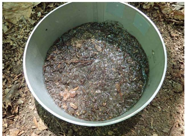
↑ **Figure 10.** Méthode Beerkan : on compare les temps d'infiltration d'un même volume d'eau entre une situation tassée et une situation non tassée.
