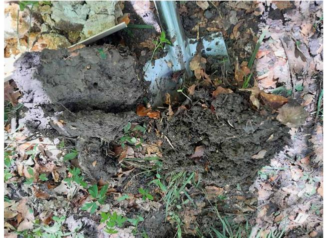
↑ **Figure 9.** Exemple de deux bûchées. Celle de droite a été prélevée hors des traces de circulation, celle de gauche dans une zone où on suspectait le passage d'engin. Photo : N. Pousse.
