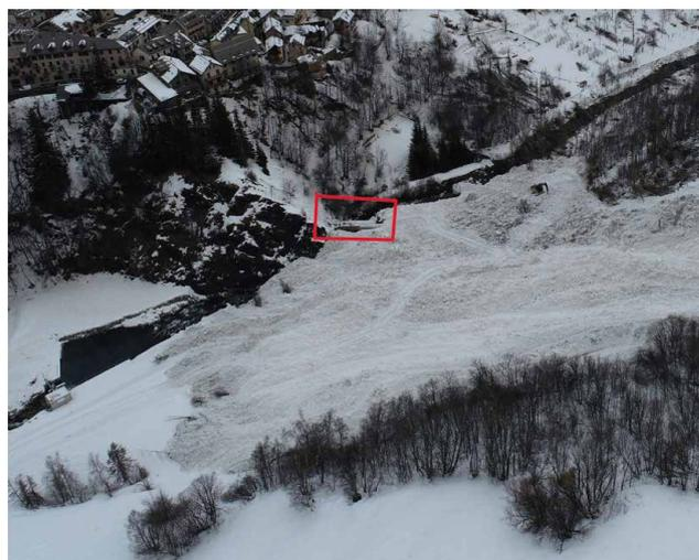
↑ **Figure 3.** Le survol drone de l'avalanche du Tabuchet – commune de La Grave (38) le 11/2/2021 – permet notamment de constater que la conduite d'eau potable a été recouverte par un dépôt de neige. Une orthophoto précise a également été réalisée pour localiser l'emprise de l'avalanche.
