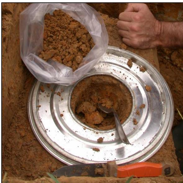
4. Placer le sac plastique dans la cavité et le plaquer contre les parois. Remplir le sac d'eau à l'aide de l'éprouvette graduée jusqu'à atteindre précisément le niveau de surface. S'assurer que le film plastique adhère bien aux parois de la cavité en rectifiant l'adhérence à l'aide de la cuillère au fur et à mesure du remplissage. Le volume de terre prélevé correspond au volume total d'eau versé dans la cavité. Noter le volume mesuré sur le sac de prélèvement et sur le rapport d'intervention.
