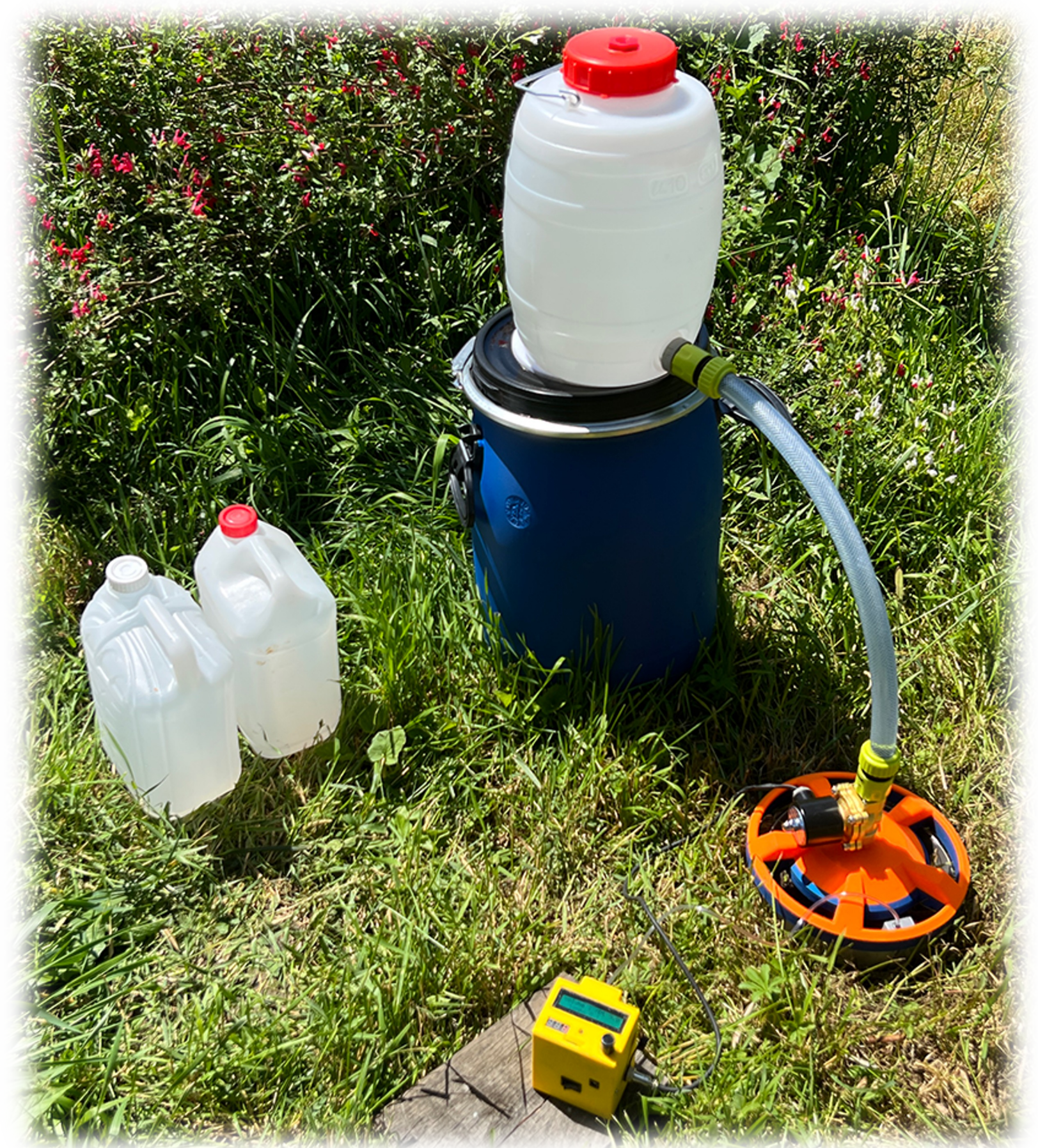
Développement de l'infiltromètre automatique Beerkan ©Biofunctool ©Pecnotlab eiwa shop 2025
