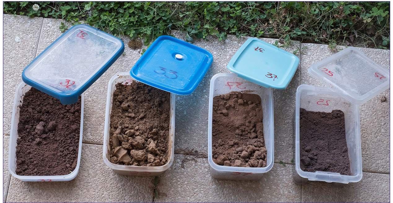
Photo 3 – Exemples de boîtes. Les boîtes 32, 33 et 37 sont des boîtes étanches, contrairement à la 25. Les boîtes et les couvercles doivent être numérotés.
