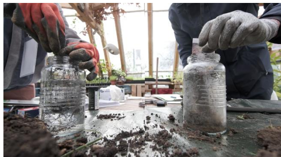
Slake test sur 2 échantillons (pleine terre et sols récemment désartificialisés), Pantin, novembre 2024
